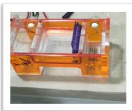
Figura 4. Se usa el peine para que pueda formarse el canal y corra el gel para completar el proceso
